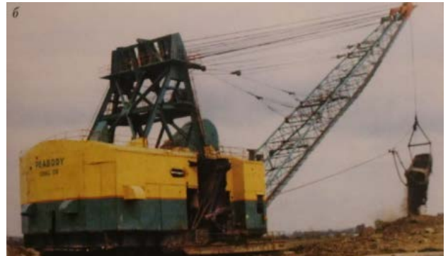
Рисунок 1.2 – Драглайн модели 7800 компании «Marion Steam Company»
