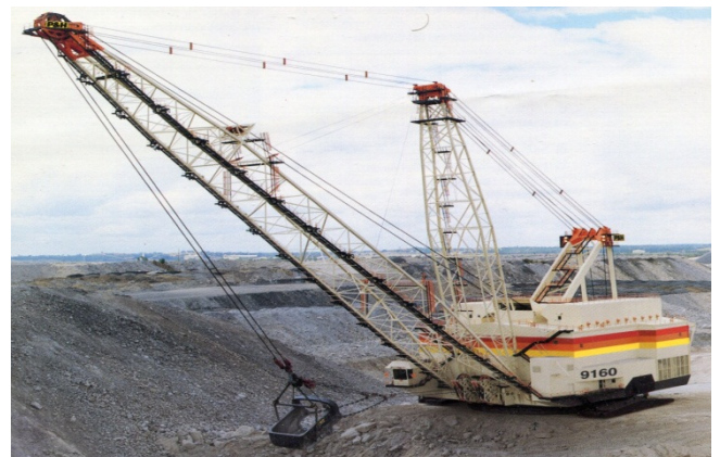
Рисунок 1.6 – Драглайн модели 9160 компании P&H Joy Global на угольном разрезе в Австралии
