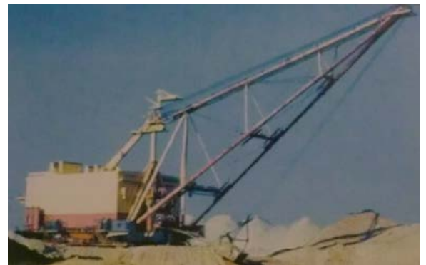
Рисунок 1.10 – Драглайн ЭШ- 100.100 на угольном разрезе «Назаровский»
