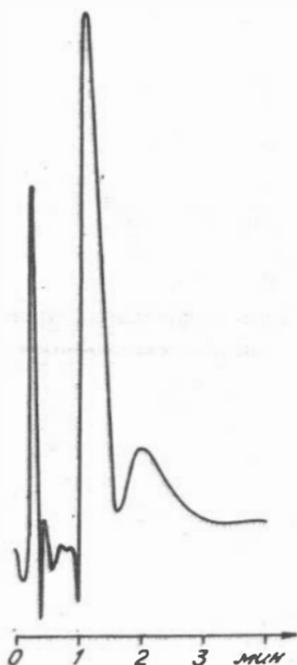
Рис.14. Хроматограмма пробы газа над грунтом в сосуде, выдержка концентратора 7 часов. [ Узон - 83 ]
