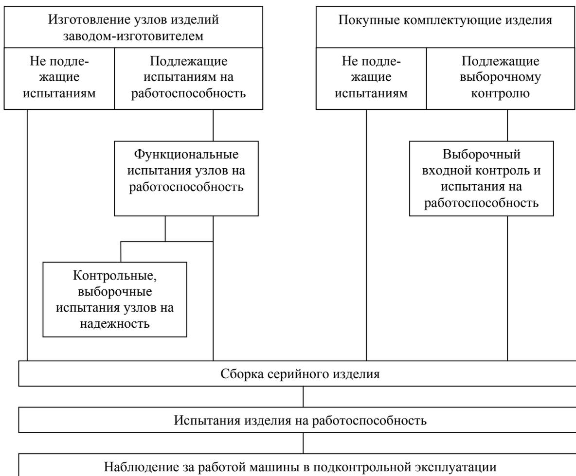
Рис. 5.2. Схема испытаний серийных машин
