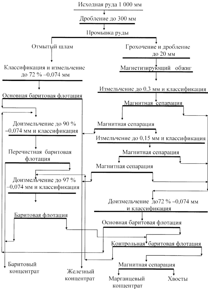
Рис. 4.3. Схема обогащения кремиковской железо-баритовой руды (НРБ)
