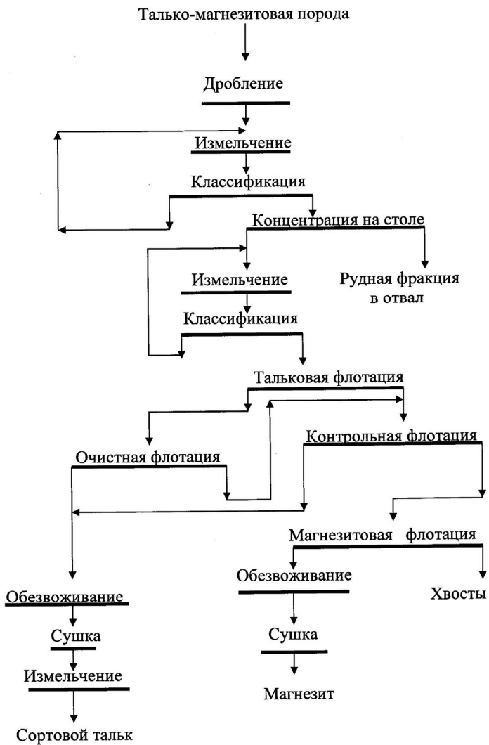
Рис. 5.4. Схема обогащения талько-магнезитовой породы
