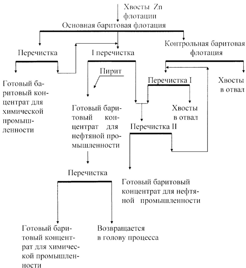
Рис. 4.1. Схема обогащения барита на Салаирской фабрике
