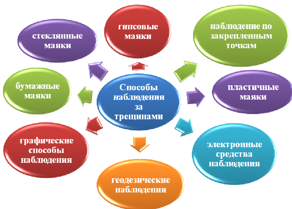
Рисунок 3.4 – Способы наблюдения за трещинами
