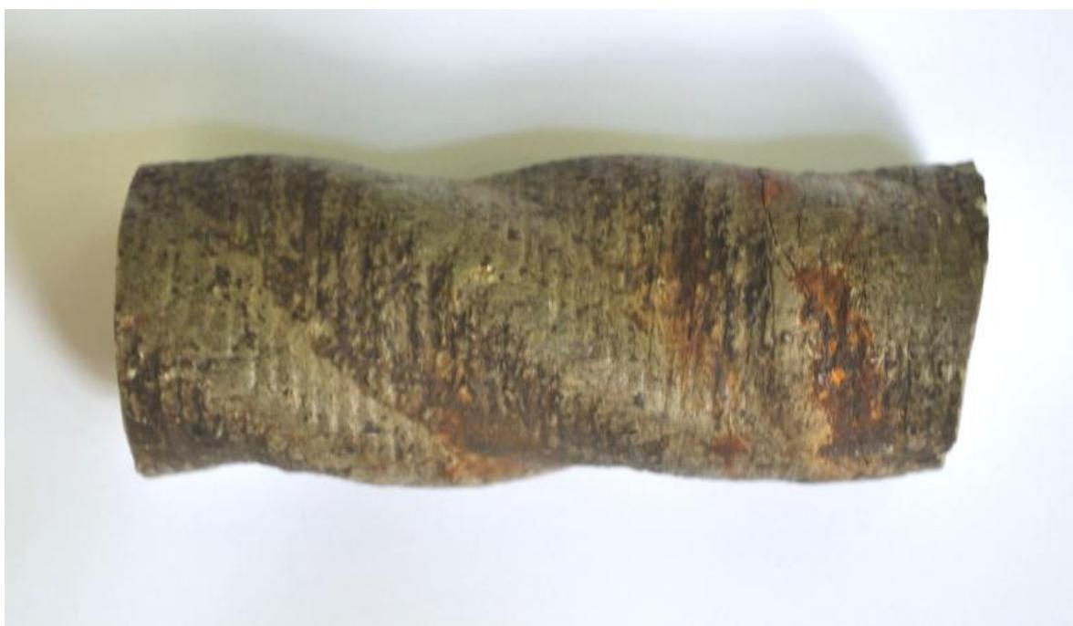
Рисунок 8.3 – Фрагмент сталеполимерного анкера после его извлечения из шпура
