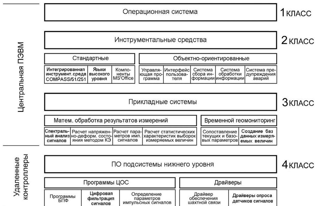
Рисунок 4.8 – Структура программного обеспечения автоматизированной системы контроля устойчивости породного массива, сбора и обработки геофизической информации
