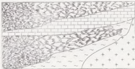
Рис. 15. Прослой баланусового известняка в марганцевой руде вблизи прилегания пласта к гранитной скале
