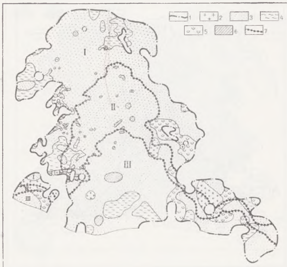
Рис. 131. Породы подошвы рудного пласта на Грушевско-Басанском участке 1 — контур рудной залежи; 2 — докембрийские породы; 3 — первичный каолин. Эоцен-олигоценые породы: 4 — глина; 5 — песок; 6 — песчаник. 7 — граница типов руд. Типы руд (цифры на карте): I — окисные II — окисные и карбонатные; III — карбонатные
