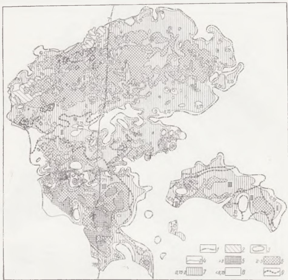
Рис. 114. Мощность рудного пласта на Западной рудоносной площади 1 — контур рудной залежи; 2 — выработанные поля; 3 — карьеры; 4 — изолинии мощности рудного пласта (проведены: 0,75, 2, 3, 4 м); 5—8 — мощность рудного пласта, м; 9 — границы типов руд. Типы руд (цифры на карте): I — окисные; II — окисные и карбонатные; III — карбонатные.
