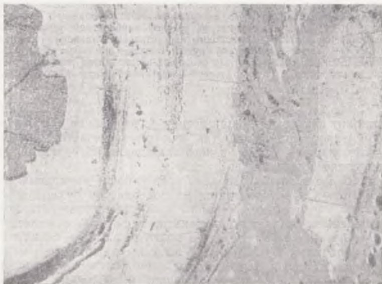
Рис. 71. Часть лимонитового пизолита с кварцевым зерном (темно-серое) в центре. Лимонит (светло-серый) замещается манганокальцитом (серый в правой части фотографии). Увел. 40
