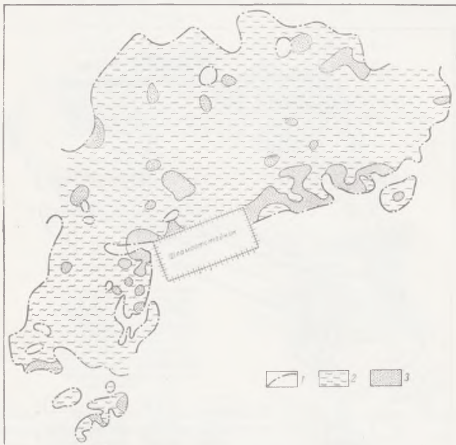
Рис. 161. Породы кровли рудного пласта на Максимова-Тимошевском участке 1 — контур рудной залежи; 2 — глина олигоценая; 3 — песок древнеаллювиальный
