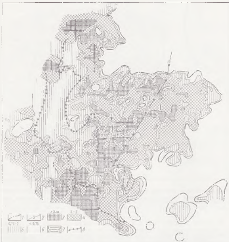
Рис. 149. Мощность рудного пласта на Комитерни-Марьевском участке 1 — контур рудной залежи; 2 — изолинии мощности рудного пласта; 3—6 — мощности рудного пласта; 7 — линия геологического разреза I—I, А—А; Б—Б; 8 — граница типов руд. Типы руд (цифры на карте): I — окисные; II — окисные и карбонатные; III — карбонатные
