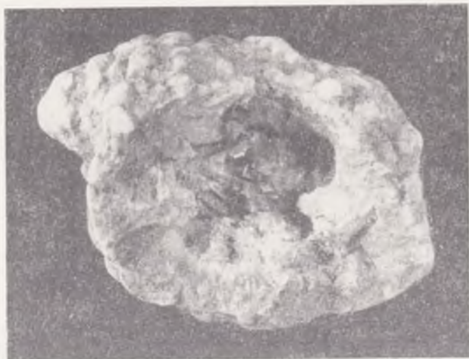
Рис. 83. Внутреннее строение баритовой конкреции из пласта карбонатной марганцевой руды. Увел. 1,35
