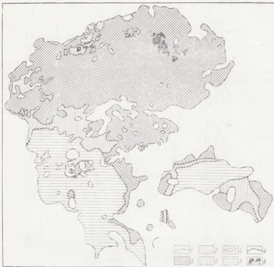
Рис. 116. Распространение типов марганцевых руд на Западной рудоносной площади 1 — контур рудной залежи; 2 — выработанные поля; 3 — карьеры; 4 — границы типов руд. Типы руд: 5 — окисная; 6 — окисная и карбонатная в виде переслаивания и смеси; 7 — карбонатная; 8 — окисная малофосфористая (пригодная для выплавки ферромарганца)
