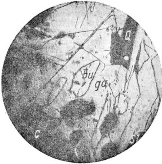
Фиг. 14. Выделения буланжерита (bu) в галените (ga) с выделениями кварца (Q), карбоната (C) и сфалерита (sl). Есауловский участок, шлиф № 42. \times 60 .
