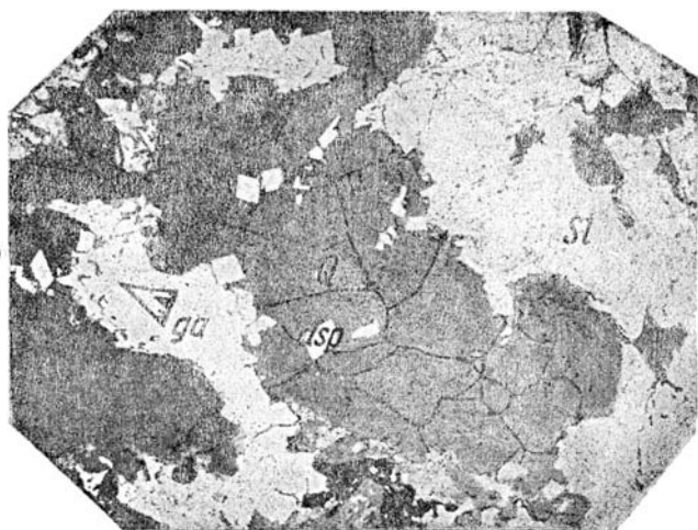
Фиг. 11. Пржилки галенита (ga) с арсенопиритом (asp) в :фалерите (sl) и кварце (Q). Участок Ближней Журавки, шурф № 8. \times 30 .
