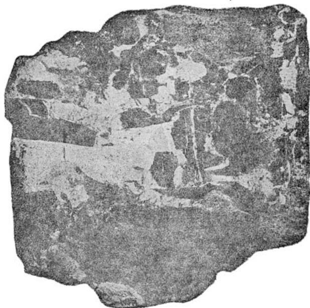
Фиг. 4. Брекчиевая текстура — обломки сфалерита, галенита и породы, сцементированные кварцем и параанкеритом. Участок шахты Утренней. Уменьшено в 2 раза.
