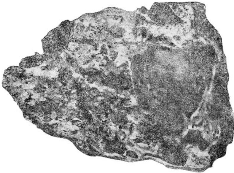
Фиг. 24. Обломки песчаника (темносерые) сцементированные водянoproзрачными кристалликами кварца (четвертой генерации). Центральный участок, жила Надежда. Натуральная величина.
