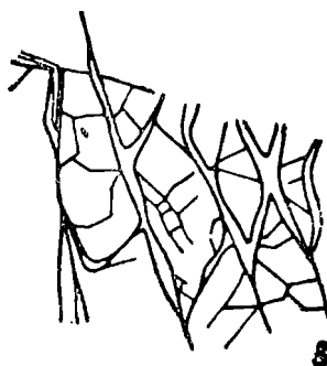
Фиг. 4. Алмазно-петельчатая текстура лимонита по галениту. Курган. А — фрагмент текстуры образца из тела № 4. Отчетливо видно двойниково (местами тройное) строение стенок и облегающая их корка неполношлакового лимонита. × 6. Б — фрагмент текстуры образца из тела № 5. Видны мелкие реликты кливажной (кубической) текстуры. × 5.
