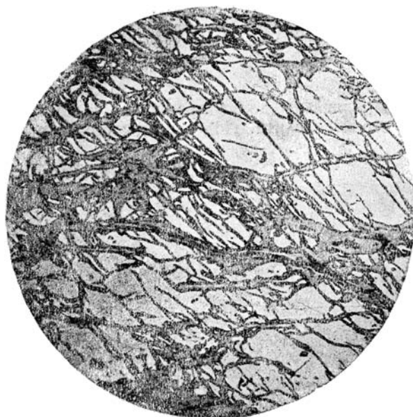
Фиг. 13. Петельчатая структура замещения бурнонита (основная масса) малахитом, азуритом и халькозитом. Есауловский участок, шлиф № 29. \times 60 .
