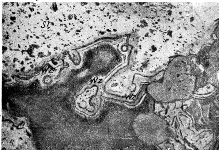
Фиг. 27. Коллоидная структура вуртцита (wz), окаймляющего выделения сфалерита (st). Есауловский участок, шлиф № 14. \times 60 .
