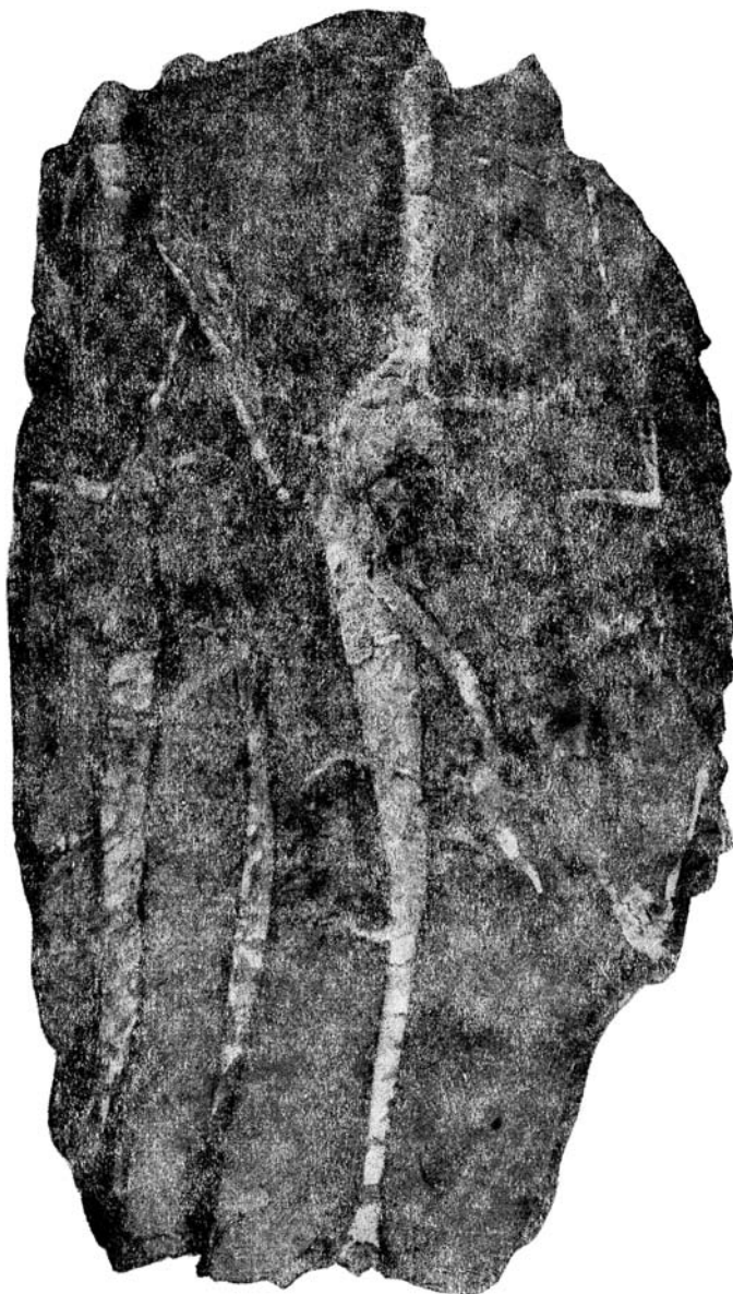
Фиг. 26. Прожилки кварца и карбоната с сульфидами в глинистом сланце. Прожилки с оторочками зеленого каолинита. Участок шахты Утренней. Натуральная величина.
