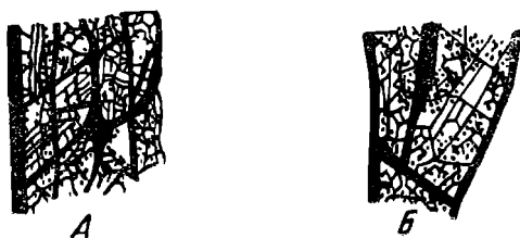
Фиг. 10. Характер грубоячейчатой ящичной текстуры: А — по сфалериту и Б — по халькопириту. В первом случае заметно прочное соединение стенок ячеек, большой параллелизм и обилие мелких перепонок, во втором — скопление порошковидного лимонита. По Р. Бланчарду и П. Босвеллу. \times 2 .
