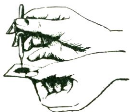
Рис. 3. Определение химического элемента по цветному пятну
