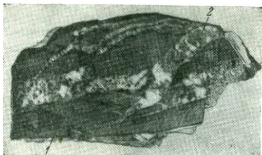
Рис. 5. Пришлифовка, покрашенная азотнокислой медью и обработанная аммиаком; 2/3 натуральной величины.
