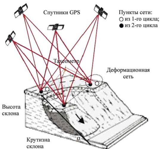
Рис. 3.1. Принципиальная схема сочетания методов ГНСС и наземной съемки для изучения оползней
