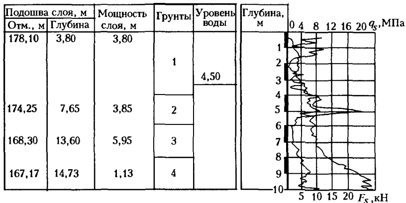
Рис.Ф.2.13. Примерный график статического зондирования:
