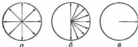
Фиг. 13. Распределение векторов намагничивания в поликристаллах.
