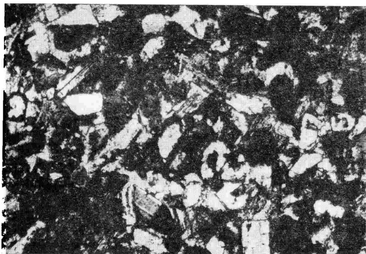
Рис. 5. Аркозовый песчаник с глауконитом, частью обломочным, частью аутигенным. Бахчисарайский район, р. Бодрак, мел. Увел. 50', николи скрещены.
