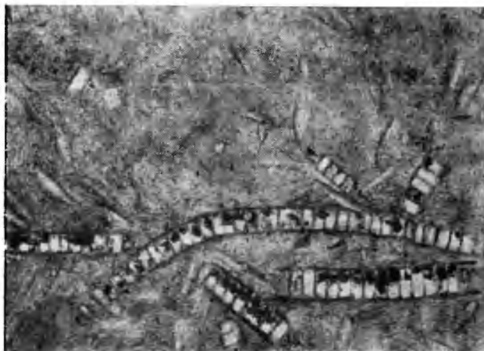
Рис. 67. Диатомит с крупными нитевидными диафоллиями хорошей сохранности. Армянская ССР, палеоген. Увел. 100 \times , николь 1.
