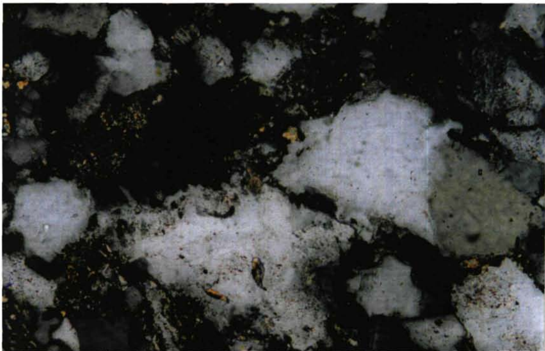
Рисунок 3.3 - Регенерация и растворение кварцевых зерен в песчанике мелкозернистом, аркозовом: а - скв. 675 Уренгойская пл, гл. 3567,6 м, обр. 882; б - скв. 675 Уренгойская пл., гл. 3579,5 м, обр. 894. Ачимовская толща клиноформы Ач 16 БУ 20 . Увел. 2340, николи X.
