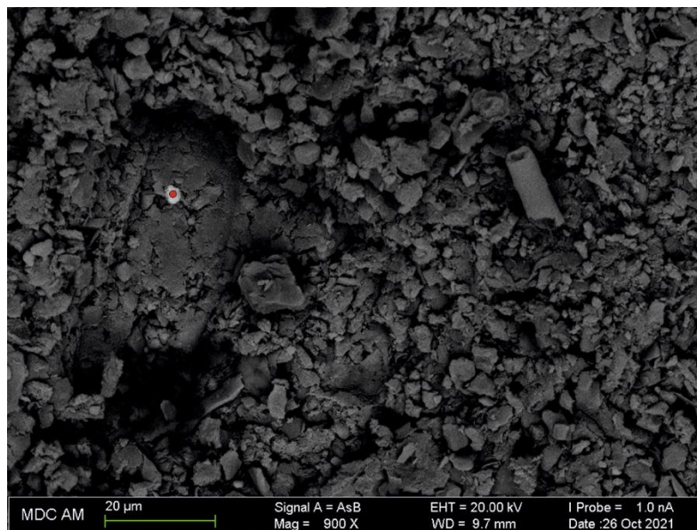
Рисунок 4.17 – Электронно-микроскопический снимок барита в образце 491 (глубина 182 см, ~7600 л. н.) озера Сабакты, атом. Ва – 22,11%, О – 25,23%, Si – 16,68%, Al – 4,23%, Fe – 3,45%, S – 3,92%, Na – 1,90%)
