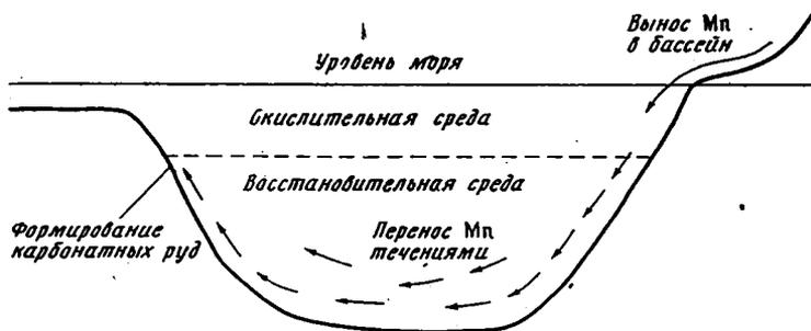
Фиг. 5. Принципиальная схема формирования карбонатных марганцевых руд
