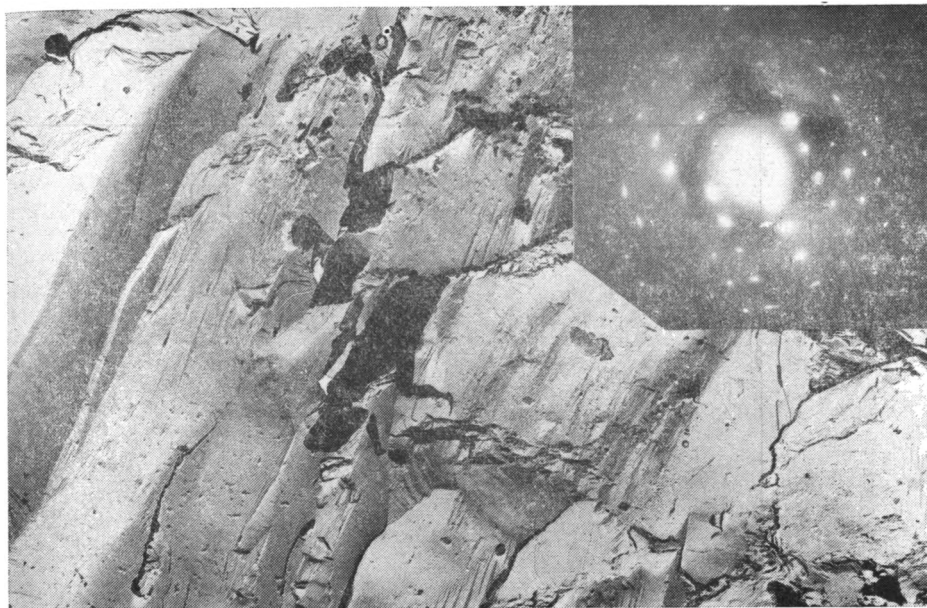
Фиг. 3. Кристаллический агрегат пирита, увел. 20 000. В правом верхнем углу точечная микродифракционная картина пирита
