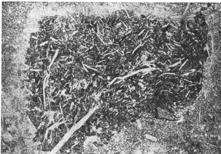
Фиг. 4. Включения кристалликов ангидрита в сере 1 — мелкозернистый ангидрит; 2 — включение серы, переполненной идиоморфными кристалликами ангидрита. Язовское месторождение, глубина 120 м, николи 11, \times 90
