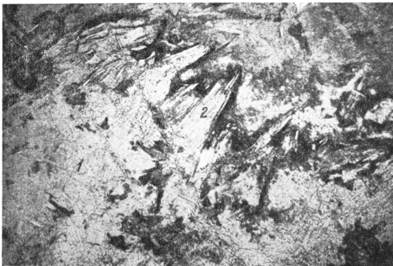
Фиг. 3. Разъедание ангидритовых кристаллов битуминозными прожилками
