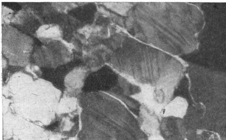
Фиг. 7. Явление «смятия» кварцевых зерен Ник. +, увел. 70
