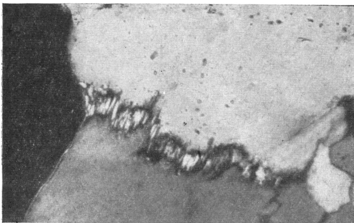
Фиг. 6. Структура дифференциального скольжения Ник. +, увел. 320
