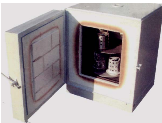
Рисунок 11. 2 - Муфельная печь для обжига опок
