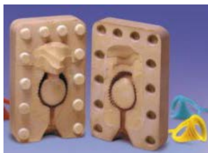
Рисунок 9.3 – Разновидности пресс-форм а - разрезанная, б - разъемная
