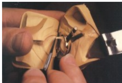
Рисунок 9.2 - Приспособление для разжатия резиновой пресс-формы
