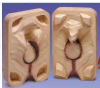
Рисунок 9.3 – Разновидности пресс-форм а - разрезанная, б - разъемная
