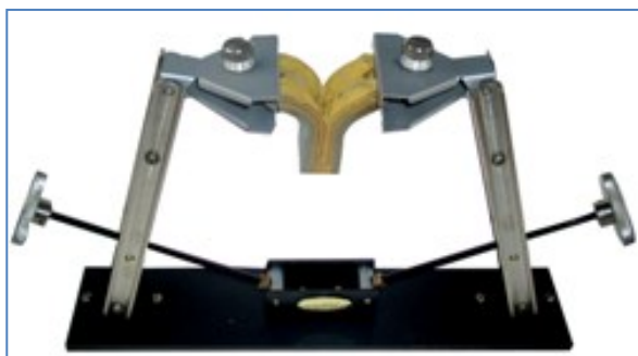
Рисунок 9.2 - Приспособление для разжатия резиновой пресс-формы
