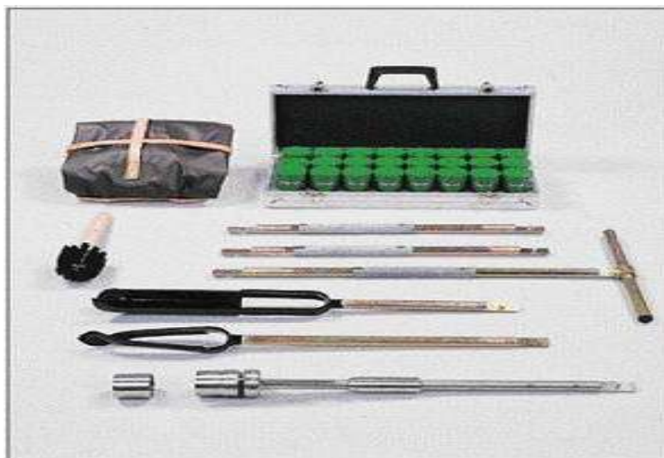
Рис.16. Бур Качинского для отбора образцов почвы
