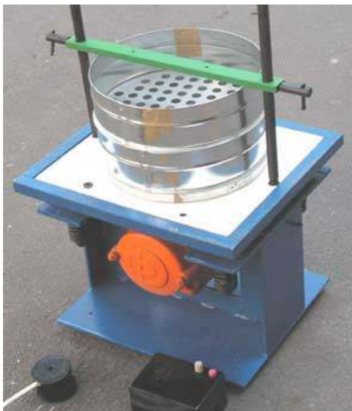
Рис.15. Установка для определения гранулометрического состава грунтов
