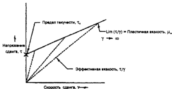
Рис. 8. Кривая течения пластичной жидкости по Бингаму
