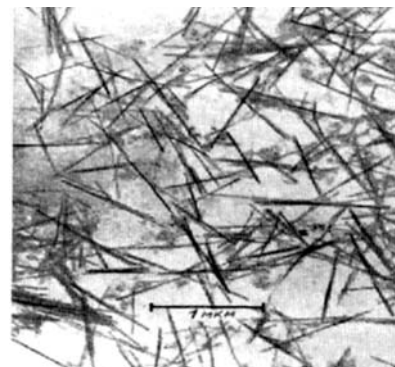
Рис. 10. Электронно-микроскопический снимок аттапульгитовой глины с открытосетчатой структурой (увеличение в 45 тыс. раз)
