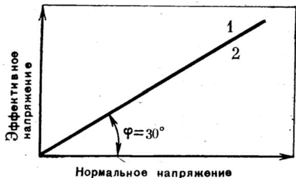
Рис. 9. Диаграмма Мора для несцементированного песка. Прочность сцепления равна нулю. Сброс происходит, когда \sigma_3 = \sigma/3 1 — зона неустойчивости; 2 — зона устойчивости
