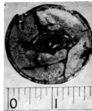
Рис. 22. Обваливание глинистого сланца митчелл в ствол скважины при постоянном напряжении. Концентрации напряжений возникали из-за существовавших до вскрытия пород ориентированных трещин
