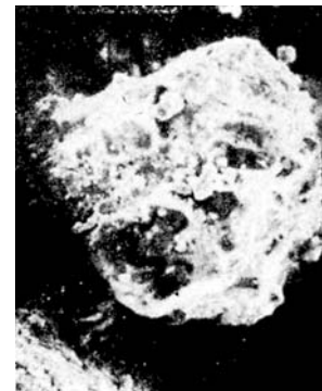
Рис. 7. Мелкие частицы, располагающиеся на поверхностях основной породы и зерен
