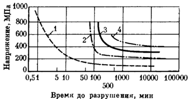
Рис. 5. Влияние напряжения на разрушение при водородном охрупчивании для материалов с различной прочностью при растяжении: 1 — отпущенный мартенсит (номинальная прочность при растяжении 2070 МПа); 2 — отпущенный мартенсит (1030 МПа); 3 — отпущенный мартенсит (980 МПа); 4 — перлит (520 МПа)
