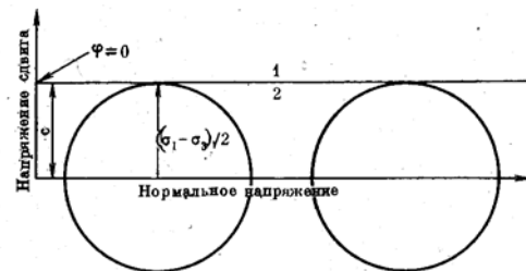
Рис. 11. Диаграмма Мора для нелитифицированной глины. Угол внутреннего трения \varphi равен нулю в сильно пластичном материале. Разрушение происходит, когда \sigma_1 - \sigma_3 в 2 раза больше прочности сцепления c : 1 — зона неустойчивости; 2 — зона устойчивости
