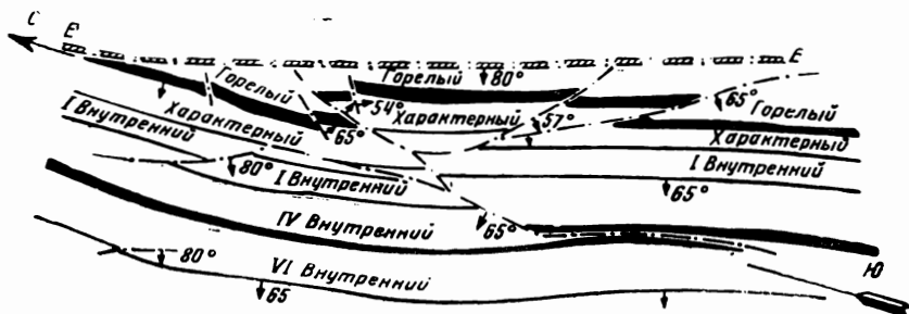
Рис. 23. Схематическая пластовая карта восточного крыла III синклинали. Поле шахты им. Ворошилова Прокопьевского района, Кузнецкого бассейна
