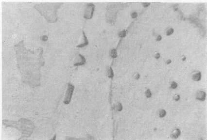
Рис. 42. Выделения минерала, приуроченные к зонам роста вольфрамита. Электронномикроскопический снимок образца вольфрамита. Ув. 4400 \times
