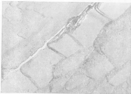
Рис. 38. Структурно-морфологические особенности излома, близкого к перпендикулярному по отношению к плоскости спайности (обр. 50), наблюдается столбчатая отдельность. Электронномикроскопический снимок, угольная реплика, ув. 7500 \times
