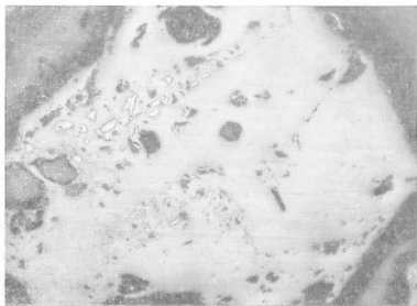
Рис. 18. Структура распада твердого раствора касситерита и танталита. Микрофото полированного шлифа. Ув. 150×
