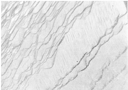
Рис. 35. Микроскульптуры роста на плоскости спайности вольфрама (обр. 1001); электронномикроскопический снимок, угольная реплика, ув. 7500 \times
