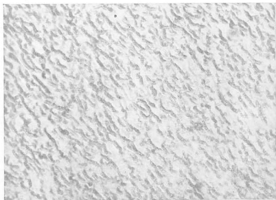
Рис. 32. Электронномикроскопический снимок с излома образца вольфрамита состава 31% MnWO_4 . Угольная реплика. Ув. 15 000 \times
