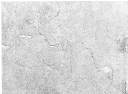
Рис. 25. Электронномикроскопический снимок с излома образца касситерита, не содержащего тантал и ниобий. Ув. 7500 \times
