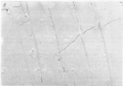
Рис. 26. Электронномикроскопические снимки с изломов образцов касситерита с содержанием тантала и ниобия 4,126%:
