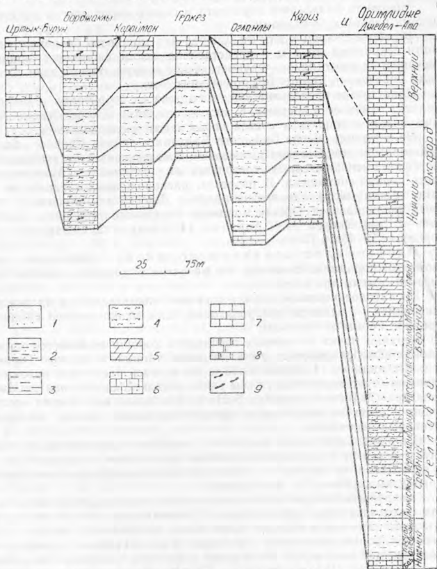
Рис. 1. Сопоставление разрезов келловейских и оксфордских отложений Большого Балхана. 1—Песчаник; 2—алевролит песчаный; 3—алевролит; 4—глина; 5—мергель; 6—известняк песчаный; 7—известняк; 8—доломит; 9—окремнение.
