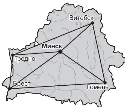
Рис. 1.15. Схема высокоточной геодезической сети (ВГС) Республики Беларусь
