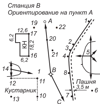
Рис. 7.8. Пример абриса тахеометрической съемки: 1–22 – реечные точки
