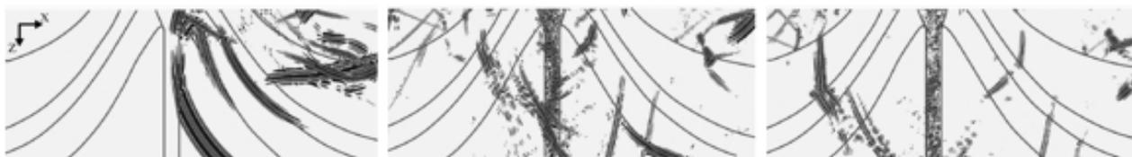
Рис. 2. Вертикальные компоненты волнового поля в последовательные моменты времени по профилю А-А1 (рис. 1). Линиями отмечены границы слоев антиклинальной структуры вулкана и центрального канала
