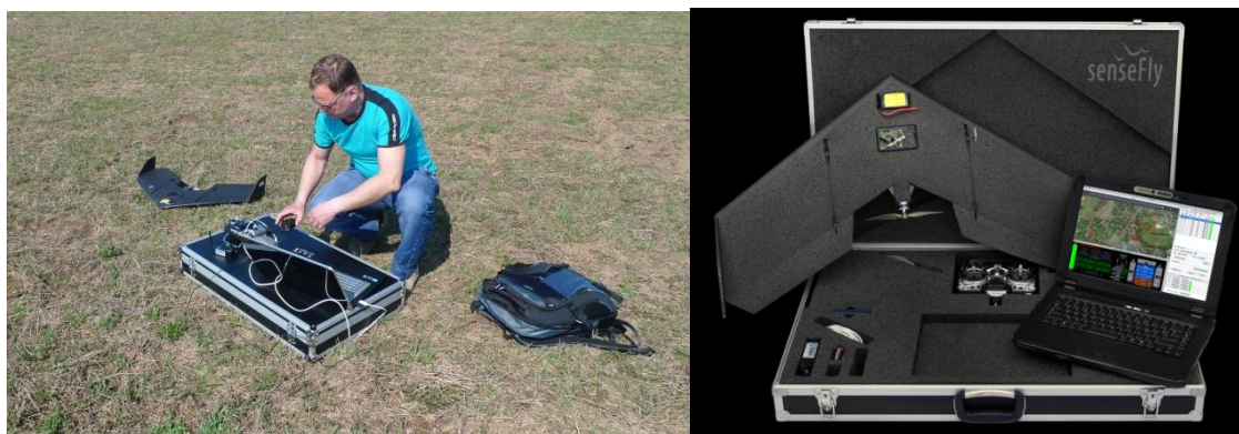
Рис. 3. Небольшие размеры и масса БПЛА удобны для транспортировки и требуют малого времени подготовки к полетам
