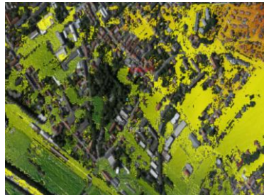
«Плотная» ЦМР, фильтрация строений и рас- тительности
