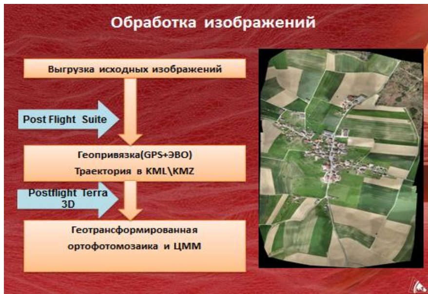
Рис. 4. Этапы обработки снимков с БПЛА Swinglet
