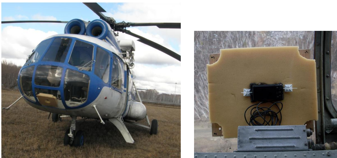
Рис. 1.: а) размещение камеры в вертолёте; б) демпферная установка
