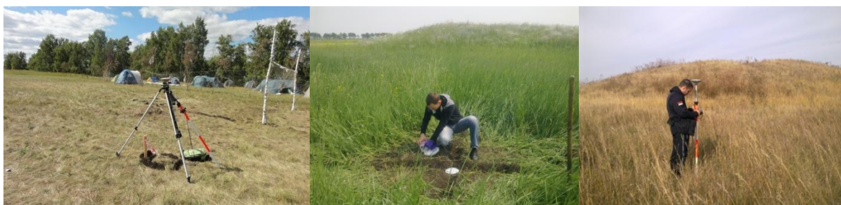
Рис. 3. Базовая станция, маркировка и привязка опознаков
