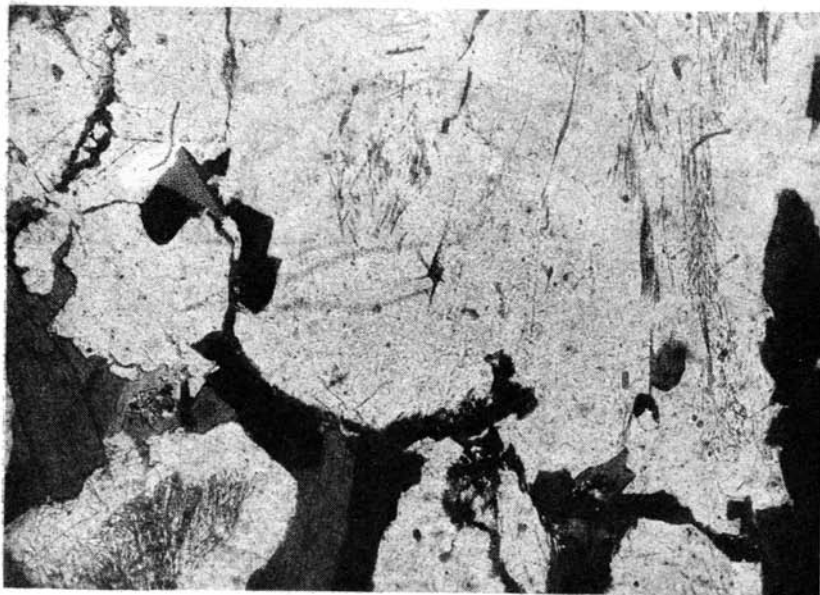
Фиг. 12. Парагенез кордиерита с силлиманитом. Плеохроичные оболочки и шагреньевая поверхность кордиерита. Гранат-кордиеритовый гранит. Жежелев, УССР. Об. св. \times 26 .
