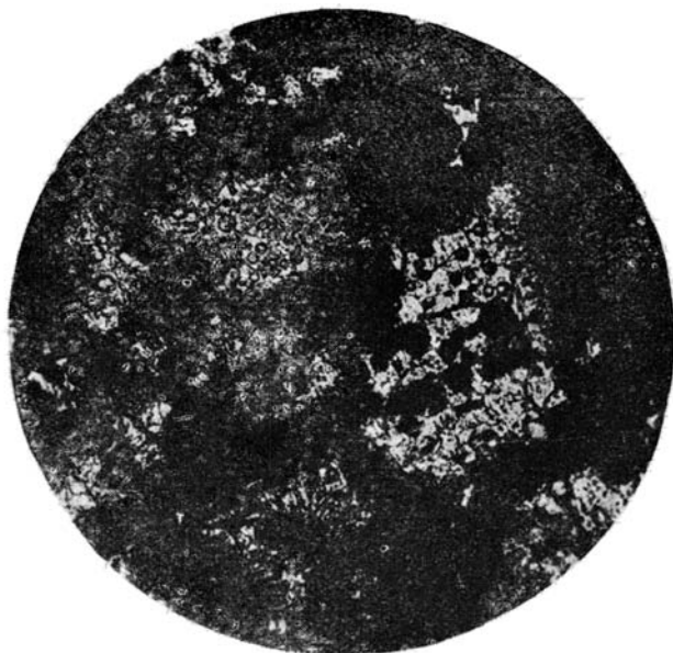
Фиг. 3. Включения стекла в фаялите из карабашского шлака. Свет простой. \times 90 .
