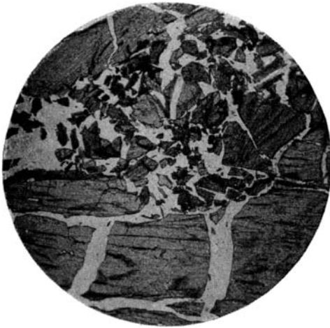
Фиг. 3. Сплав: 80 мол. % \text{CaMgSi}_2\text{O}_6 ; 20 мол. % \text{CaFe}_2\text{SiO}_6 . Увел. 10, без анализатора
