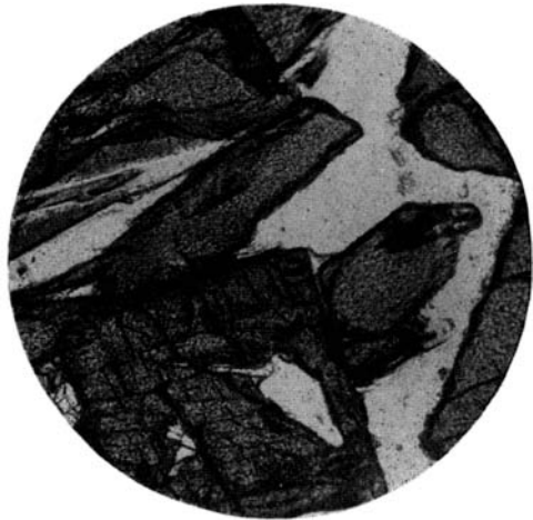
Фиг. 6. Сплав: 50 мол. % \text{CaMgSi}_2\text{O}_6 ; 50 мол. % \text{CaFe}_2\text{SiO}_6 . Увел. 90, без ана- лизатора.
