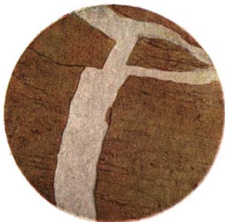
Фиг. 9. Сплав: 80 мол. % \text{CaMgSi}_2\text{O}_6 ; 20 мол. % \text{CaFe}_2\text{SiO}_6 . Увел. 46, без анализатора. Цветная фотография.
