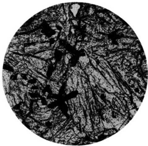
Фиг. 32. Сплав: 60 мол. % \text{CaMgSi}_2\text{O}_6 ; 40 мол. % \text{CaTiAl}_2\text{O}_6 . Полная кристаллизация, пироксен + перовскит. Увел. 90, без анализатора.
