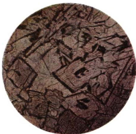
Фиг. 26. Сплав: 70 мол. % \text{CaMgSiO}_6 ; 30 мол. % \text{CaTiAlSiO}_6 . Увел. 46, без анализатора. Цветная фотография.
