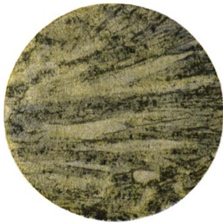
Фиг. 45. Сплав: 60 мол. % \text{CaMgSi}_2\text{O}_6 ; 40 мол. % \text{CaVAISiO}_6 . Увел. 46, без анализатора. Цветная фотография.
