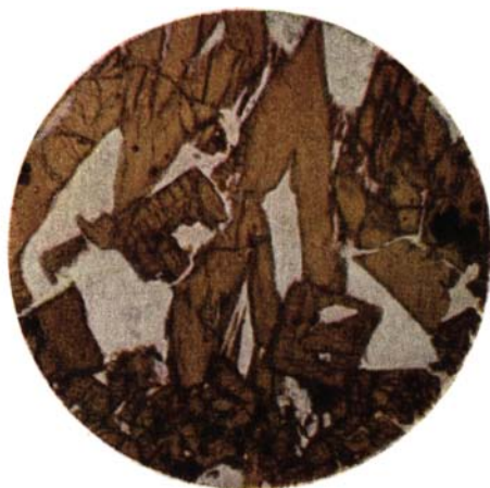
Фиг. 10. Сплав: 50 мол. % \text{CaMgSi}_2\text{O}_6 ; 50 мол. % \text{CaFe}_2\text{SiO}_6 . Увел. 46, без анализатора. Цветная фотография.
