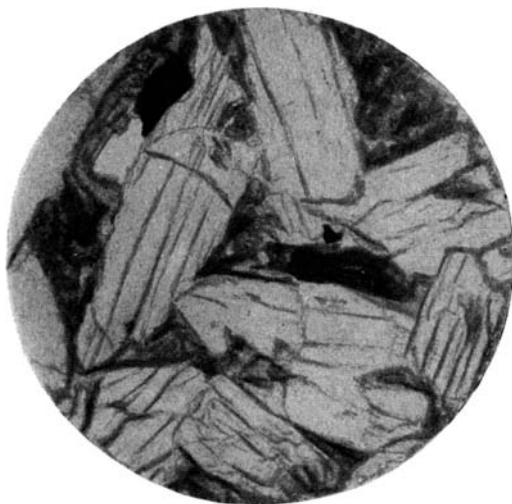
Фиг. 35. Сплав: 80 мол. % \text{CaMgSi}_2\text{O}_6 ; 20 мол. % \text{CaTiFe}_2\text{O}_6 . Пироксен + перовскит. Увел. 90, без анализатора.
