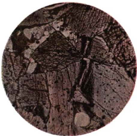
Фиг. 44. Сплав: 90 мол. % \text{CaMgSi}_2\text{O}_6 ; 10 мол. % \text{CaV}_2\text{SiO}_6 . Увел. 46, без анализатора. Цветная фотография.
