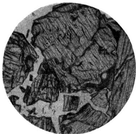
Фиг. 39. Сплав: 80 мол. % \text{CaMgSi}_2\text{O}_6 ; 20 мол. % \text{CaVAlSiO}_6 . Увел. 46, без анализатора.
