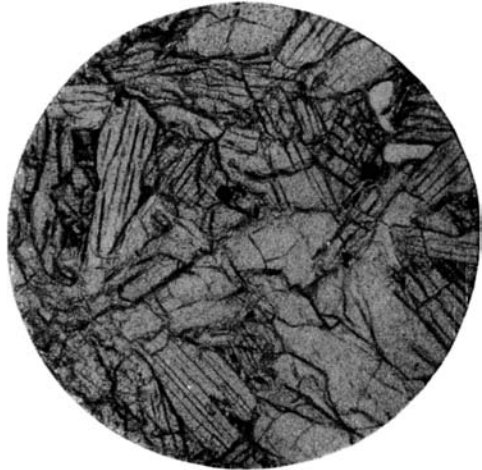
Фиг. 4. Сплав: 75 мол. % \text{CaMgSi}_2\text{O}_6 ; 25 мол. % \text{CaFe}_2\text{SiO}_6 . Увел. 46, без ана- лизатора.
