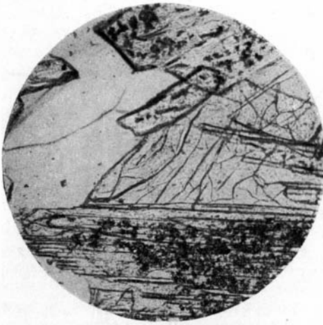
Фиг. 48. Сплав: 90 мол. % \text{CaMgSi}_2\text{O}_6 ; 10 мол. % \text{CaCr}_2\text{SiO}_6 . Кристаллы пироксена содержат включения; стекло (в центре шлифа) свободно от включений. Увел. 90, без анализатора.
