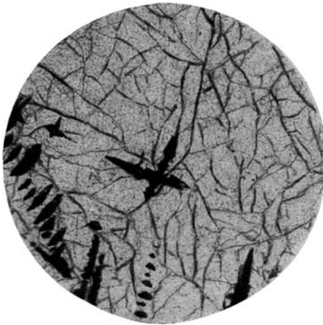
Фиг. 31. Сплав: 60 мол. % \text{CaMgSi}_2\text{O}_6 ; 40 мол. % \text{CaTiAl}_2\text{O}_6 . Выделения перовскита в стекле (закалка 1320^\circ ). Увел. 90, без анализатора.
