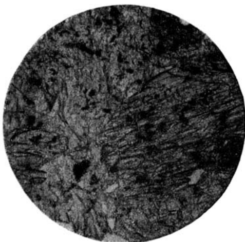
Фиг. 40. Сплав: 60 мол. % \text{CaMgSi}_2\text{O}_6 ; 40 мол. % \text{CaVAlSiO}_6 . В пироксене вкрапленность \text{V}_2\text{O}_5 . Увел. 46, без анализатора.
