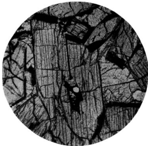
Фиг. 22. Сплав: 70 мол. % \text{CaMgSi}_2\text{O}_6 ; 30 мол. % \text{CaTiAlSiO}_6 . Увел. 46, без анализатора.
