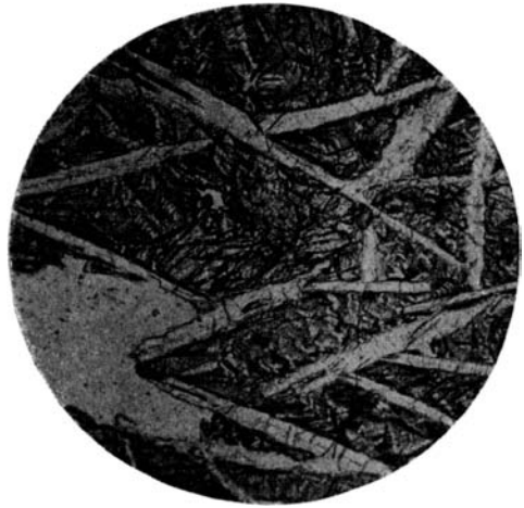
Фиг. 15. Сплав: 50 мол. % \text{CaMgSi}_2\text{O}_6 ; 50 мол. % \text{CaAl}_2\text{SiO}_6 . Пироксен, анортит, мелилит, шпинель, стекло. Увел. 46, без анализатора.
