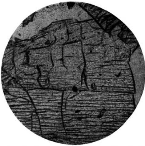
Фиг. 29. Сплав: 80 мол. % \text{CaMgSi}_2\text{O}_6 ; 20 мол. % \text{CaTiAl}_2\text{O}_6 . Увел. 90, без анализатора.
