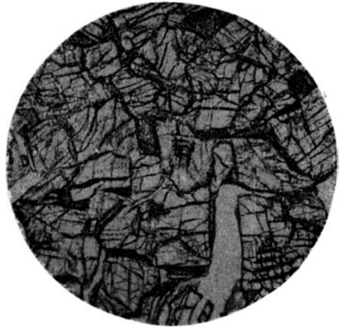
Фиг. 13. Сплав: 70 мол. % \text{CaMgSi}_2\text{O}_6 ; 30 мол. % \text{CaAl}_2\text{SiO}_6 . Увел. 46, без анализатора.
