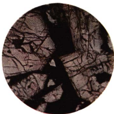
Фиг. 27. Сплав: 60 мол. % \text{CaMgSi}_2\text{O}_6 ; 40 мол. % \text{CaTiAlSiO}_6 . Увел. 46, без анализатора. Цветная фотография.
