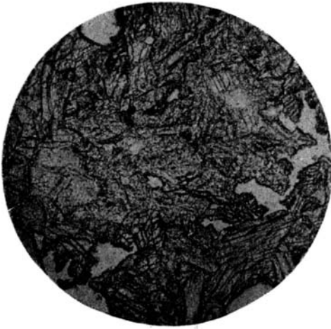
Фиг. 12. Сплав: 80 мол. % \text{CaMgSi}_2\text{O}_6 ; 20 мол. % \text{CaAl}_2\text{SiO}_6 . Увел. 46, без анализатора.
