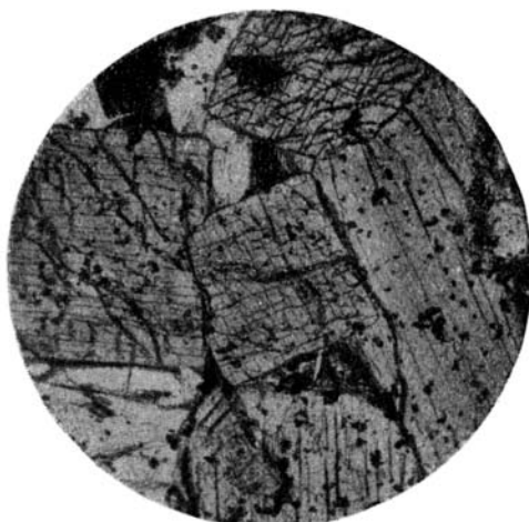
Фиг. 38. Сплав: 90 мол. % \text{CaMgSi}_2\text{O}_6 ; 10 мол. % \text{CaV}_2\text{SiO}_6 . В пироксене ред- кая вкрапленность \text{V}_2\text{O}_5 . Увел. 46, без анализатора.
