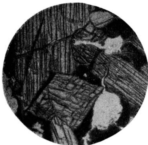
Фиг. 37. Сплав: 95 мол. % \text{CaMgSi}_2\text{O}_6 ; 5 мол. % \text{CaV}_2\text{SiO}_6 . Увел. 46, без анализатора.
