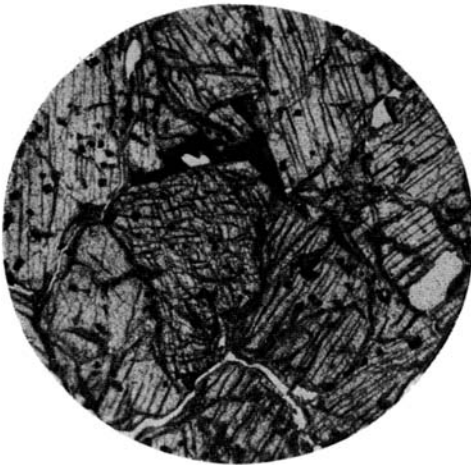
Фиг. 5. Сплав: 70 мол. % \text{CaMgSi}_2\text{O}_6 ; 30 мол. % \text{CaFe}_2\text{SiO}_6 . Увел. 10, без ана- лизатора.
