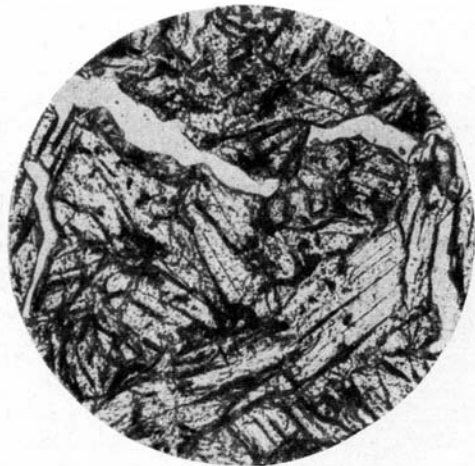
Фиг. 51. Сплав: 80 мол. % \text{CaMgSi}_2\text{O}_6 ; 20 мол. % \text{CaCrAlSiO}_6 . Полная кристаллизация. Включений в пироксене меньше, чем в образце фиг. 48. Увел. 90, без анализатора.
