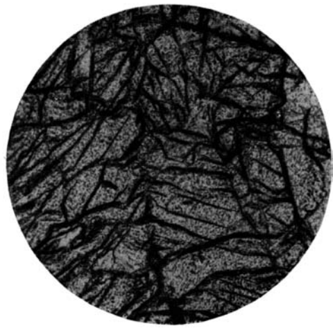
Фиг. 30. Сплав: 70 мол. % \text{CaMgSi}_2\text{O}_6 ; 30 мол. % \text{CaTiAl}_2\text{O}_6 . Увел. 90, без анализатора.
