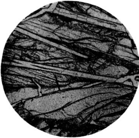
Фиг. 14. Сплав: 60 мол. % \text{CaMgSi}_2\text{O}_6 ; 40 мол. % \text{CaAl}_2\text{SiO}_6 . Пироксен и анортит. Увел. 46, без анализатора.
