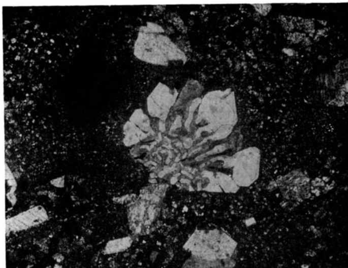
Фиг. 11. Вкрапленник — сросток кварца с ортоклазом в кварцевом порфире с криптопойкилитовой основной массой. Увел. 20, николи +.
