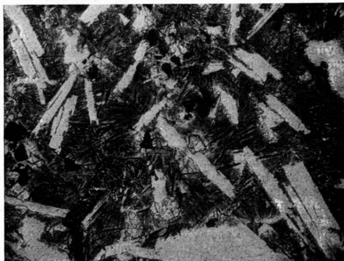
Фиг. 20. Толеитовый базальт. Микролиты авгита в стекле. Увел. 86.
