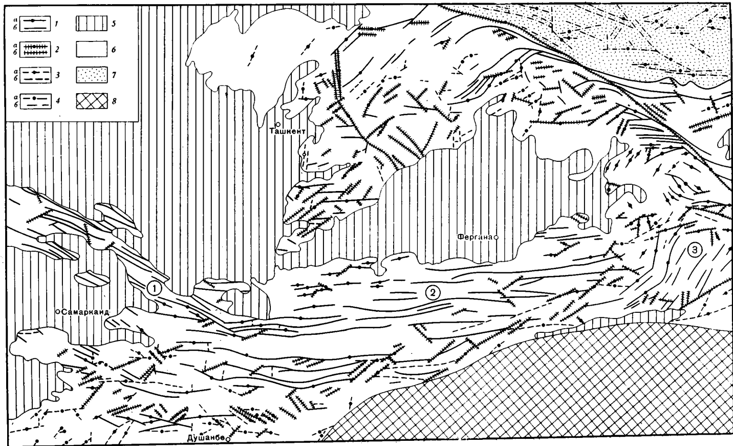
Рис. 3. Сеть разломов Западного Тянь-Шаня, активных в мезозое — кайнозое (1а, 2а, 3а, 4а — активность доказана, 1б, 2б, 3б, 4б — активность предположительна)
