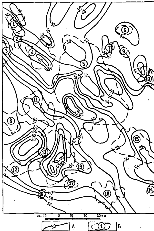
Рис. 2. Распределение теплового потока на участке Вартовского района.
