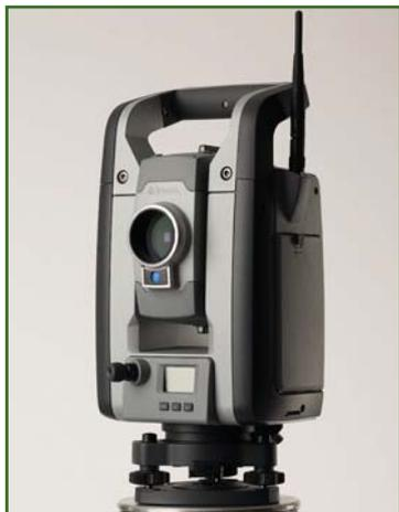
Этот прибор позволяет выполнять геодезическую съемку в трехмерном пространстве. Точки съемки отображаются на графическом экране поверх видеоизображения, обновляющегося 5 раз в секунду. Цифровые изображения объектов съемки могут быть записаны с разрешением 2048x1536 пикселей, а сервомоторы MagDrive позволяют вести сканирование со скоростью до 15 точек в секунду.
