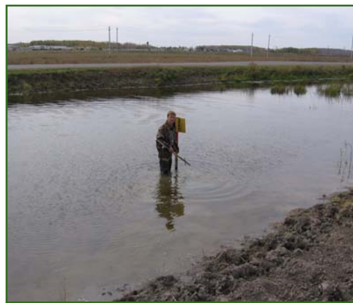
Рис. 1 Определение положения и глубины кабеля
