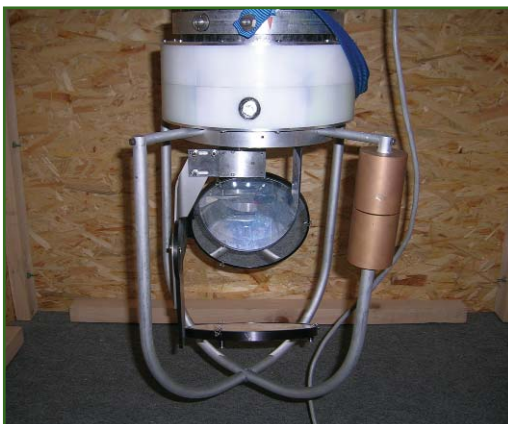
Рис. 6 Нижняя часть МЗП с ортогональным зеркалом
