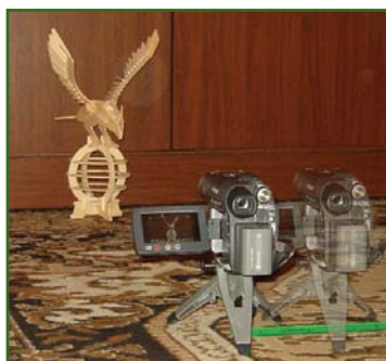
Рис. 6 Стереосъемка неподвижного объекта одной камерой с двух точек
