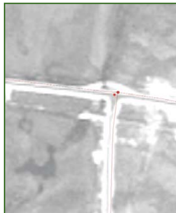
Рис. 5 Пример совмещения ортофотоизображения с осевой линией автодороги
