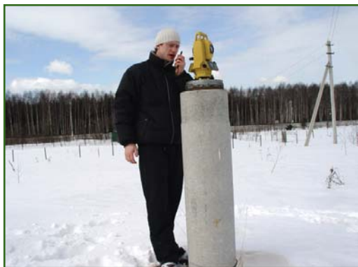
Рис. 2 Измерение расстояний на базисе
