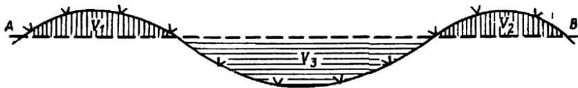
Рис. 1. Определение красной линии. Объемы перемещаемых пород:  $V_1$  и  $V_2$  — изымаемые;  $V_3$  — насыпные
