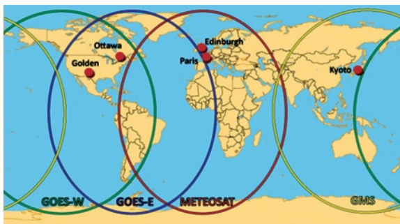
Рисунок 4.4 – Схема расположения геомагнитных информационных узлов мировой сети магнитных обсерваторий ИНТЕРМАГНЕТ. Овальными областями изображены зоны действия геостационарных спутников связи для передачи данных в GIN с обсерваторий
