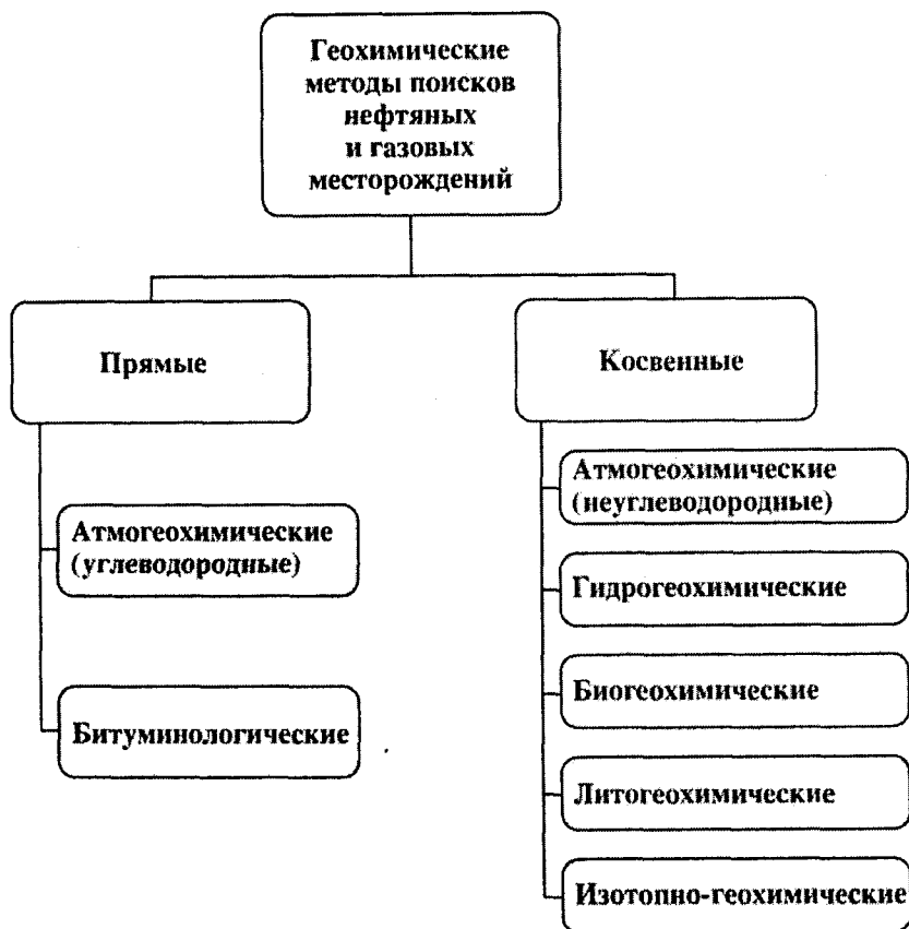
Рис. 25. Иерархия геохимических методов поисков месторождений нефти и газа (А.М. Зорькин, А.В. Петухов)
