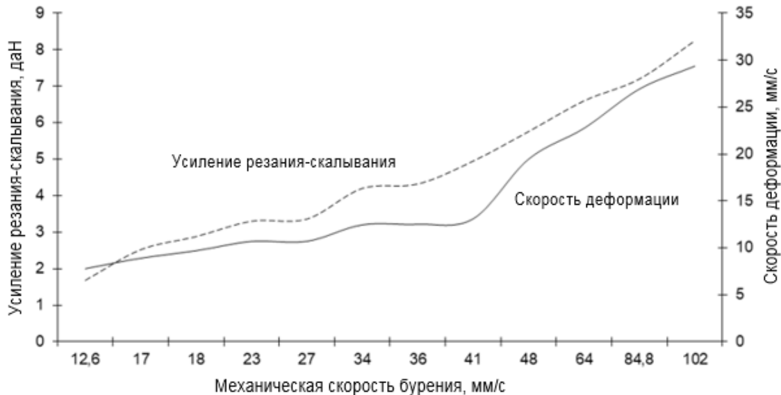
Рис. 1. Зависимости между механической скоростью бурения, усилием резания-скалывания и скоростью деформации твердой горной породы Fig. 1. Relationship between the mechanical speed of drilling, cutting-shearing force and the strain rate of the solid rock
