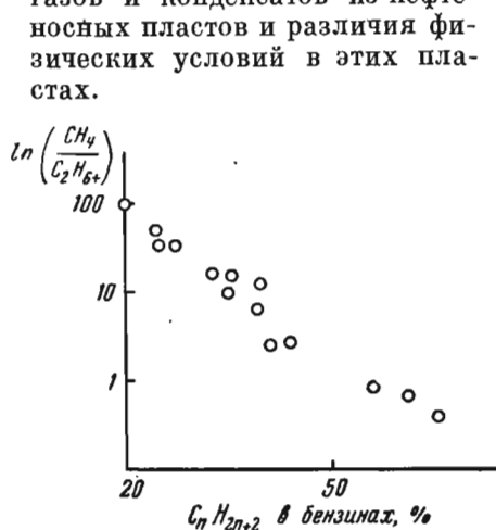
РИС. 16. Связь между углеводородным составом газов и содержанием метановых углеводородов в легких фракциях нефтей тех же пластов.
