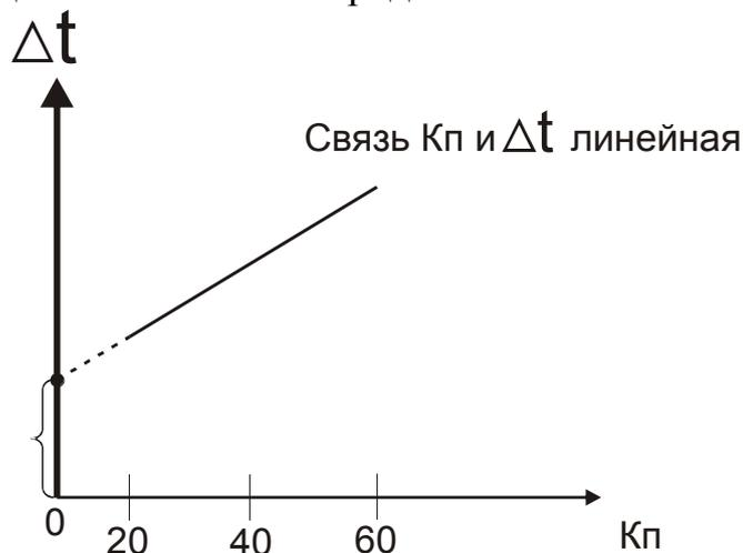
**Применение АК.** В комплексе с другими методами акустический каротаж применяется для литологического расчленения разрезов скважин, определения коэффициента пористости, в том числе трещинной и каверно-трещинной.
