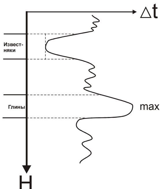
Связь между пористостью и интервалом времени  $\Delta t$ : выражается через уравнение интервала времени:
