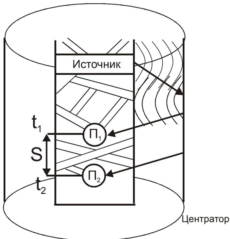
$S$  – расстояние между двумя сейсмоприёмниками.
