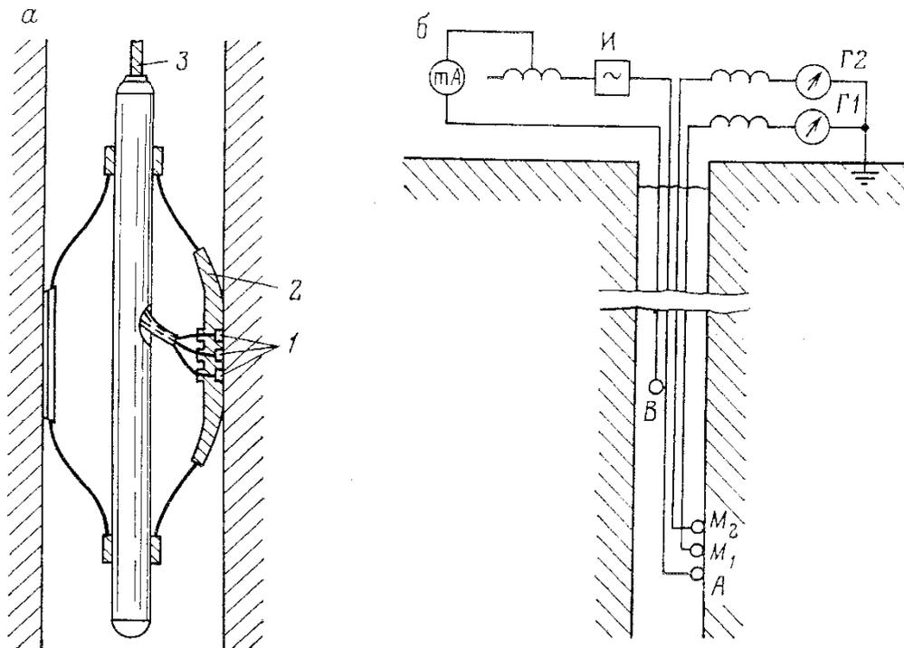
Рисунок 11 - Принципиальная схема измерений микрозондами
