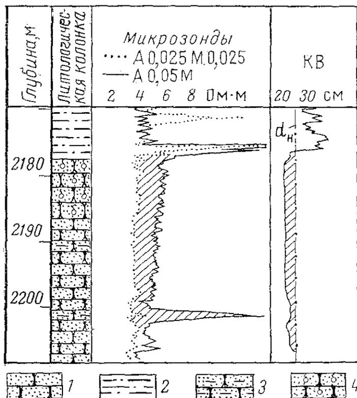
Рисунок 12 - Пример поведения кривых МКЗ и КВ в интервале образования глинистой корки над продуктивным пластом
