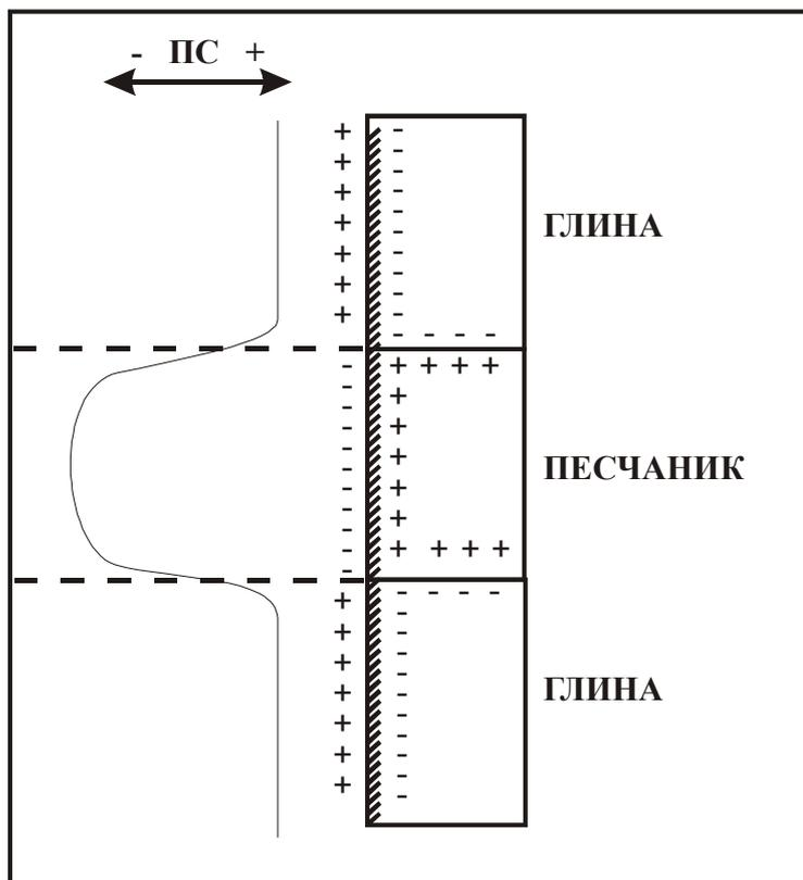
Рисунок 9 - Диффузионно-адсорбционные потенциалы, перераспределение зарядов в скважине
