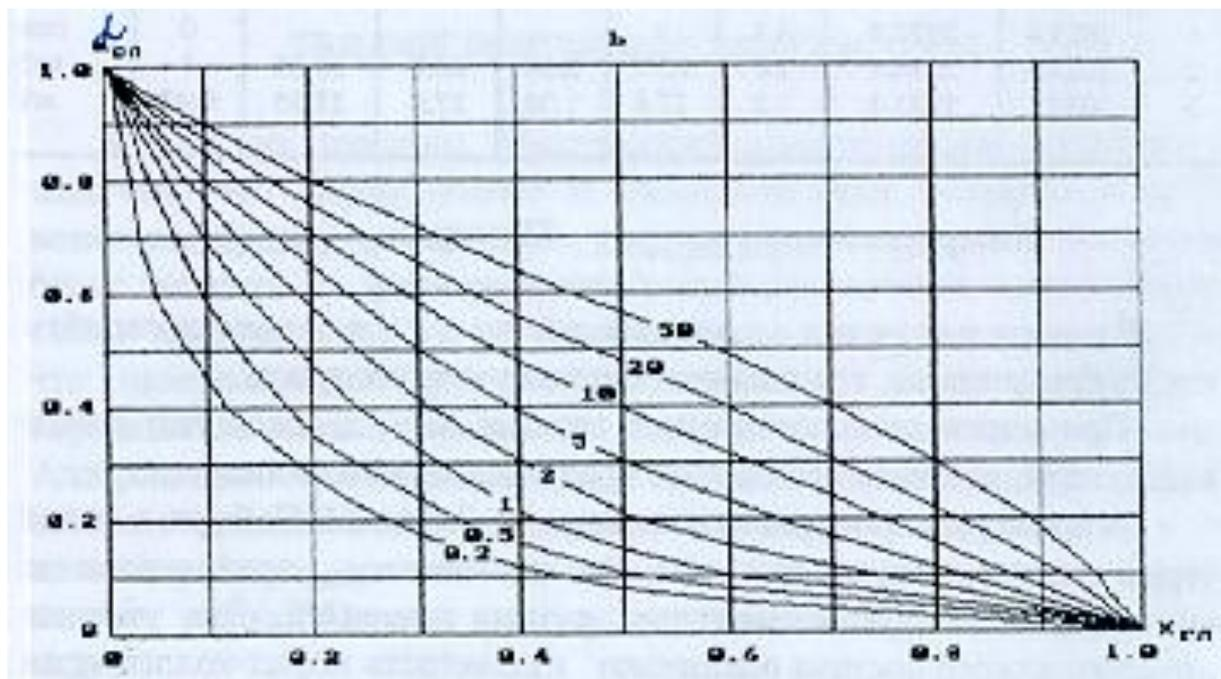
Рисунок 10 - Палетка для определения относительной глинистости по величине относительной амплитуды аномалии ПС (áпс).
