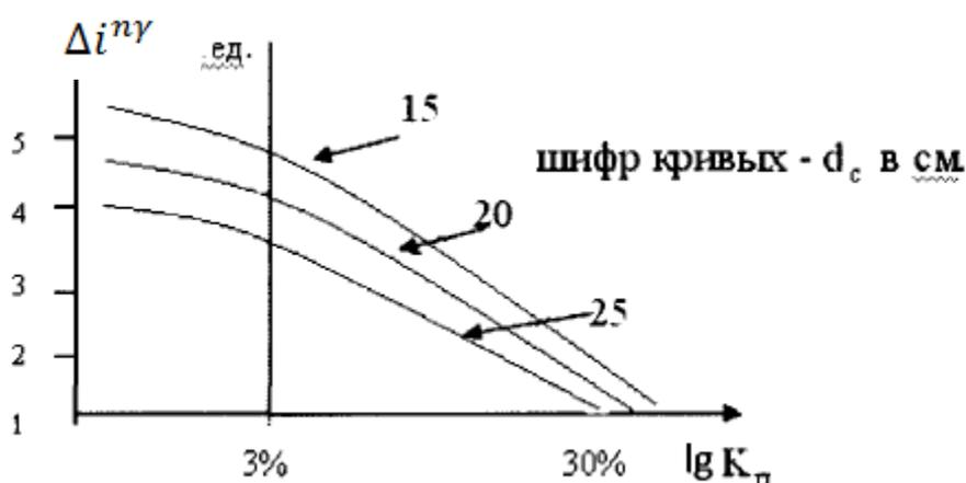
Рисунок 17 – Зависимость коэффициента пористости от интенсивности НГК
