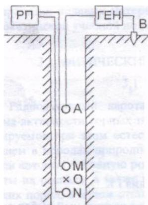
Рисунок 5- Схема проведения каротажа сопротивления (КС)
