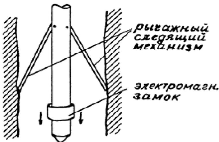
Рисунок 3 – Устройство каверномера рычажного типа
