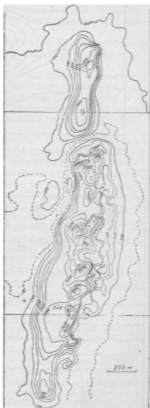
Рисунок 2. 6 - План изодинам \Delta Z над железорудным месторождением. (Д. С. Миков, А.А. Федоров, 1961).
