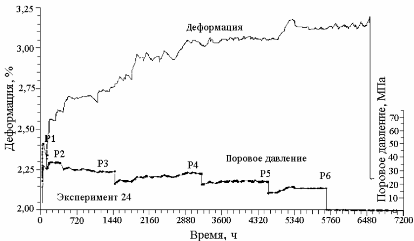
Рис. 6.5. Изменение деформации образца при моделировании быстрого снижения пластового давления
