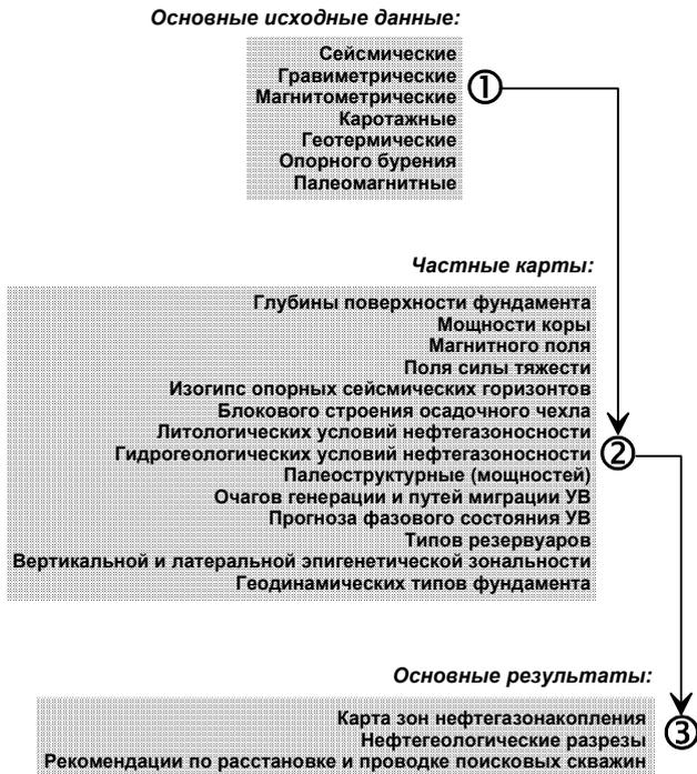
Рис. 5.7. Основные исходные данные и частные карты, используемые для определения направлений нефтегазопроисловых работ на сложные залежи нижней половины осадочного чехла.
