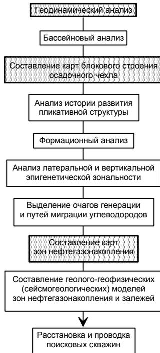
Рис. 5.5. Методика нефтегазопроисковых работ на сложные залежи нижней половины осадочного чехла.
