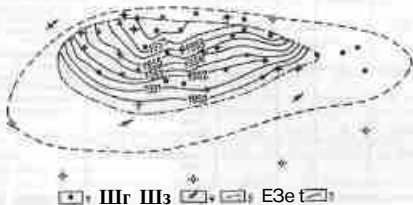
Рис. 2.3. Схема размещения фронта заводнения по пласту Б, Зольнского месторождения (обозначены: 1, 3 — добывающие скважины; 2 — активно действующий, 4 — изометрический; 5, 6 — начальный контур нефтеносности; 7 — положение фронта заводнения в различные периоды)
