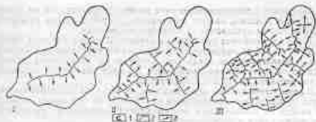
Рис. 3.20. Схема развития фильтрационной сети в пористой среде А 0 -А. Развитие сети вторичных каналов: I, II, III — этапы развития сети; IIIIII: 1 — исходный канал пористости; 2 — развивающийся вторичный канал; 3 — развитые каналы
