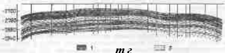
Рис. 2.6. Геологический профиль на продуктивных пластах III объекта Мухановского месторождения: 1, 2 — залежи нефти и залегающий над ними алевритовый пласт; 3 — глина; 4 — алевролит.
