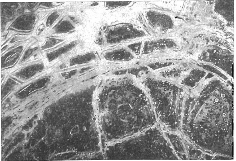
Рис. 6. Развитие интенсивной трещиноватости в периферических частях глобуль. Ув. 5 при одном никеле.
