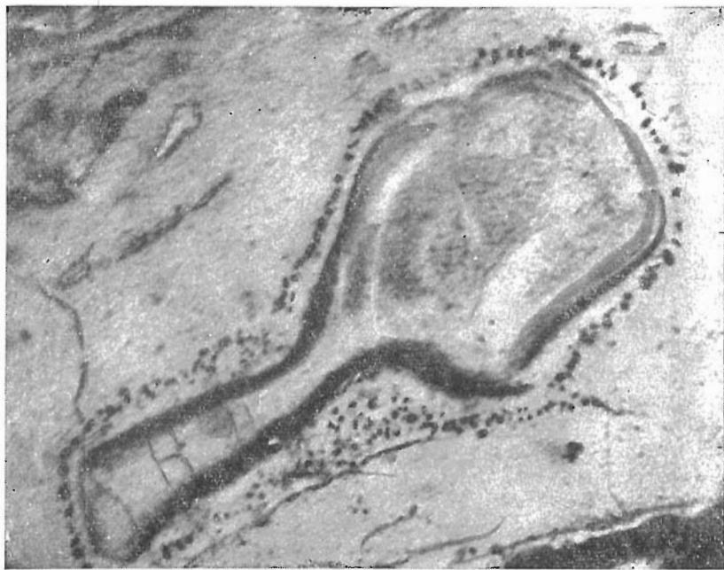
Рис. 15. Образование скоплений гематита вокруг гематитовых пленок. Ув. 40 при одном николе.
