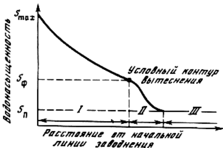
Рис. 12.2. Изменение нефтеводонасыщенности по длине пласта при вытеснении нефти водой.
