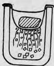
Рис. 111. Выделение кубиков хлористого калия из карналлита в соприкосновении с водой.
