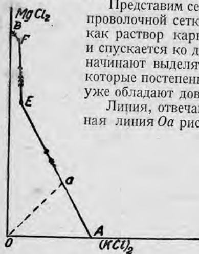
Рис. 110. BF = линия растворимости MgCl \cdot 6H_2O . FE = линия растворимости карналлита. EA = линия растворимости (KCl)_2 . Oa отвечает составу карналлита.
