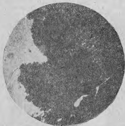
Рис. 26. Сферолитовое расстекловывание в кремневом стекле, богатом железом.
