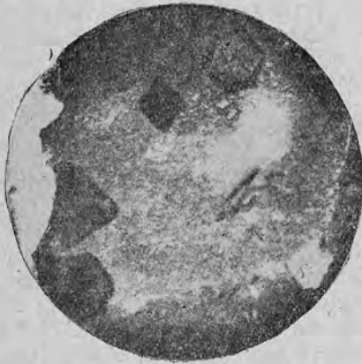
Рис. 28. Формы расстекловывания в кремневом стекле, содержащем известь.
