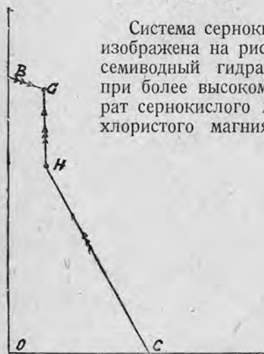
Рис. 115. B = насыщение MgCl_2 . G = насыщение MgCl_2 + MgSO_4 \cdot 6H_2O . H = насыщение MgSO_4 \cdot 6H_2O + MgSO_4 \cdot 7H_2O . C = насыщение MgSO_4 \cdot 7H_2O .
