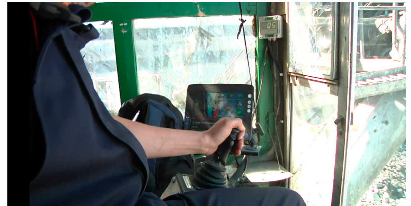
Рисунок 7.5 — Кабина экскаватора, оснащенная системой позиционирования ковша
