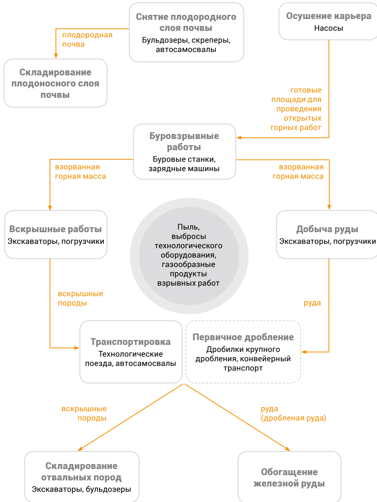
Рисунок 2.1 — Общая блок-схема процессов открытых горных работ
