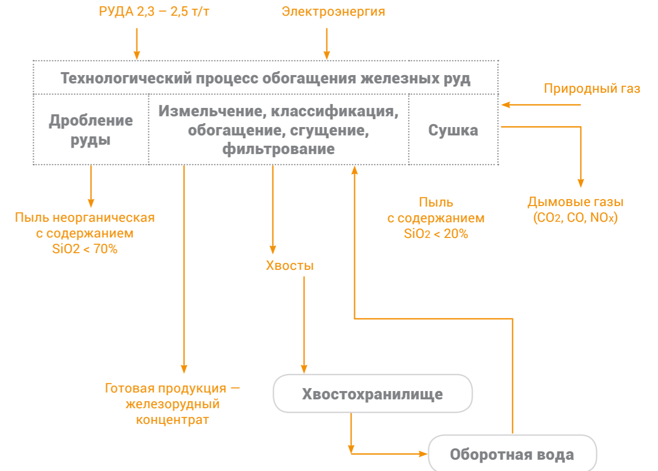
Рисунок 3.3 — Схема материальных и энергетических потоков в обогащении железных руд
