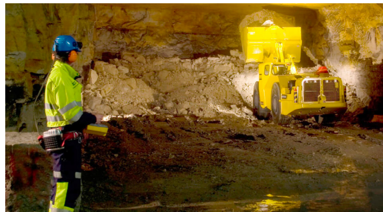
Рисунок 7.7 — Удаленное управление погрузочной машиной
