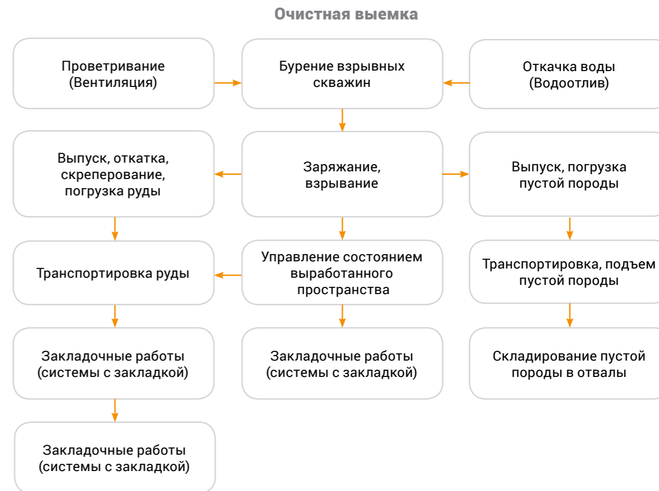
Рисунок 2.4 — Общая блок-схема процессов очистных работ
