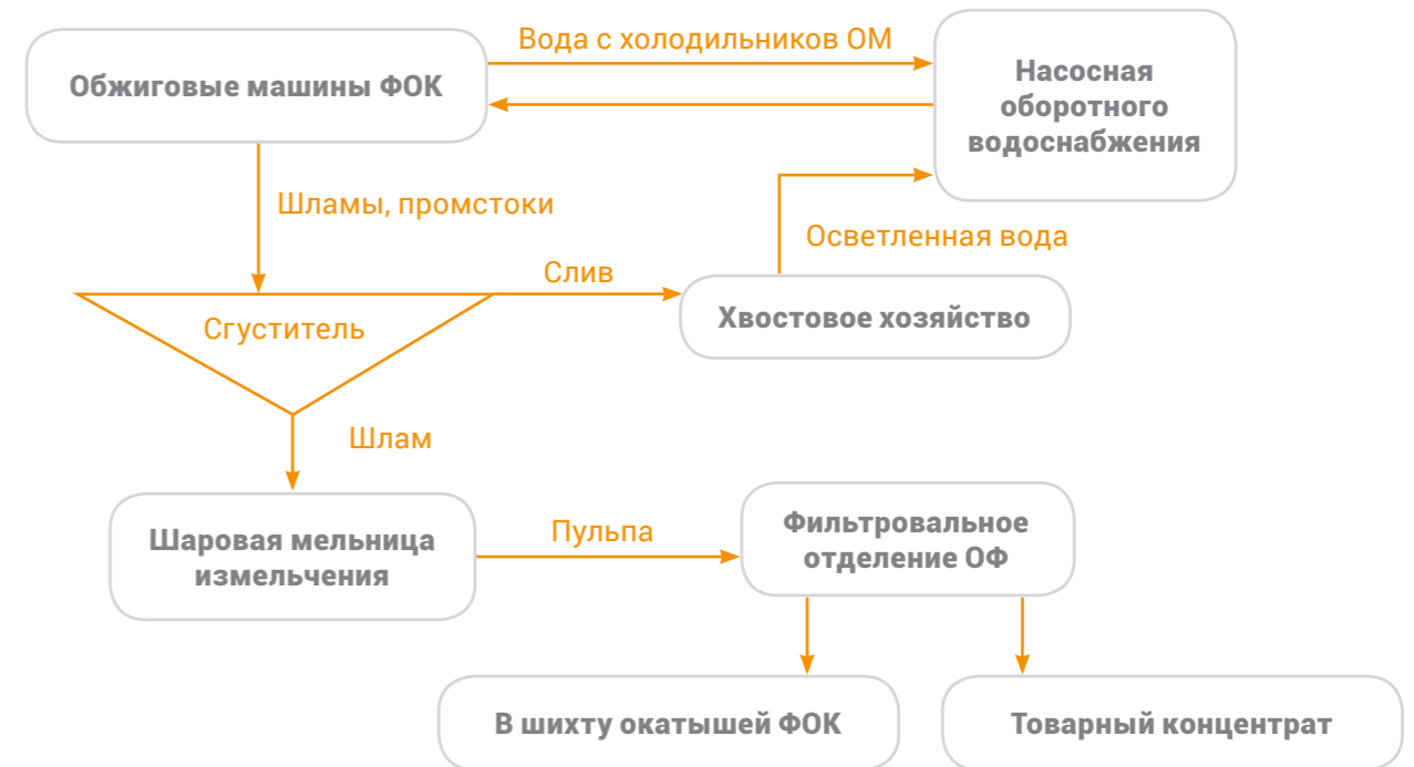
Рисунок 2.31 – Обобщенная схема движения шламов фабрик окомкования
