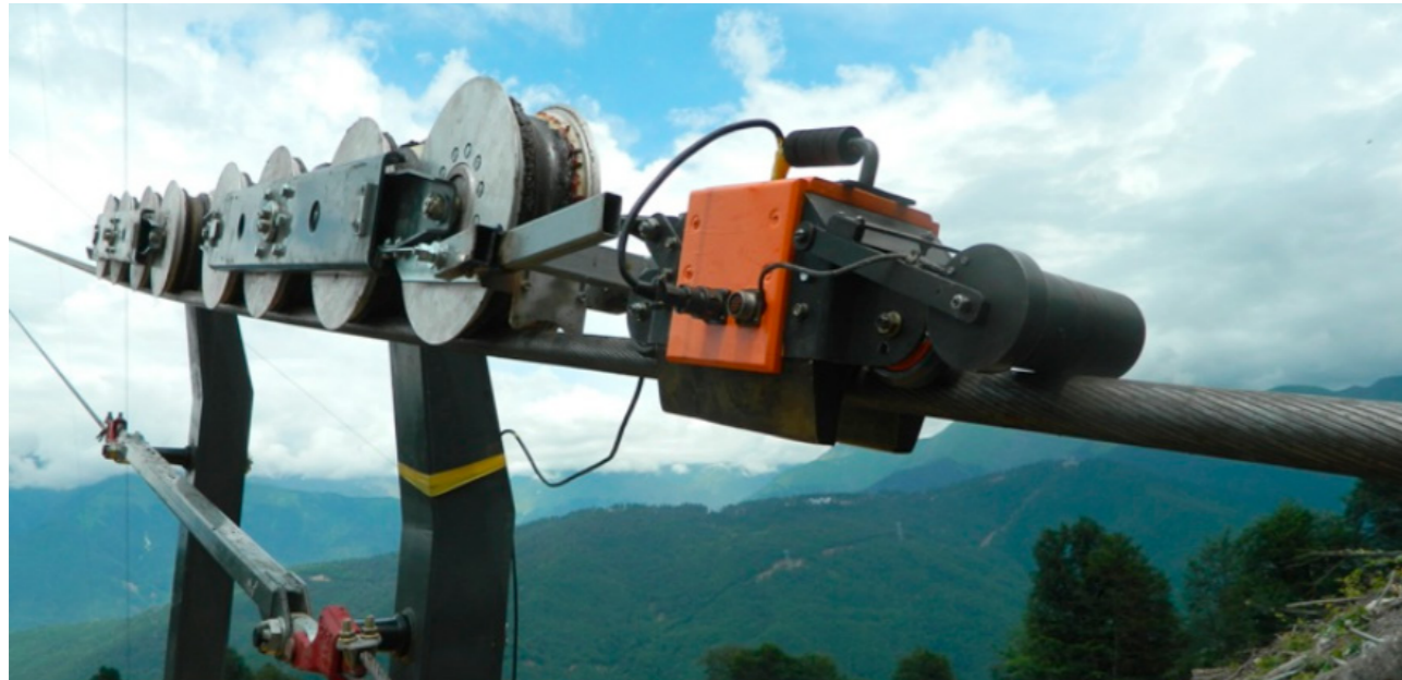
Рисунок 7.8 — Система автоматизированного мониторинга каната
