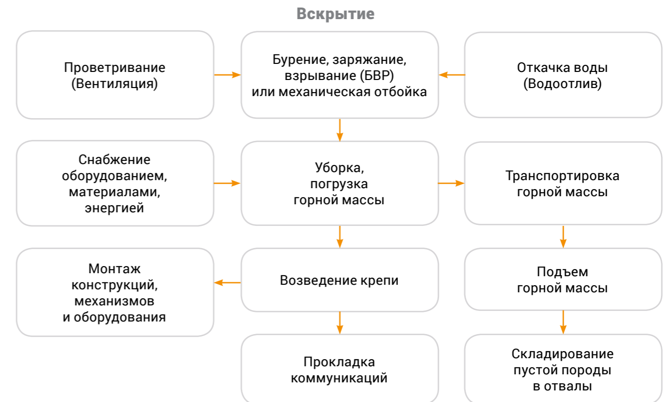
Рисунок 2.2 — Общая блок-схема процессов этапа вскрытия
