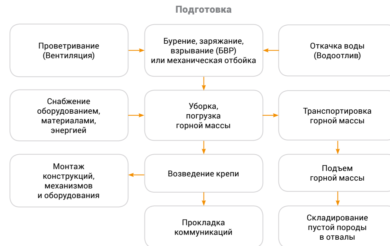
Рисунок 2.3 — Общая блок-схема процессов подготовительных работ
