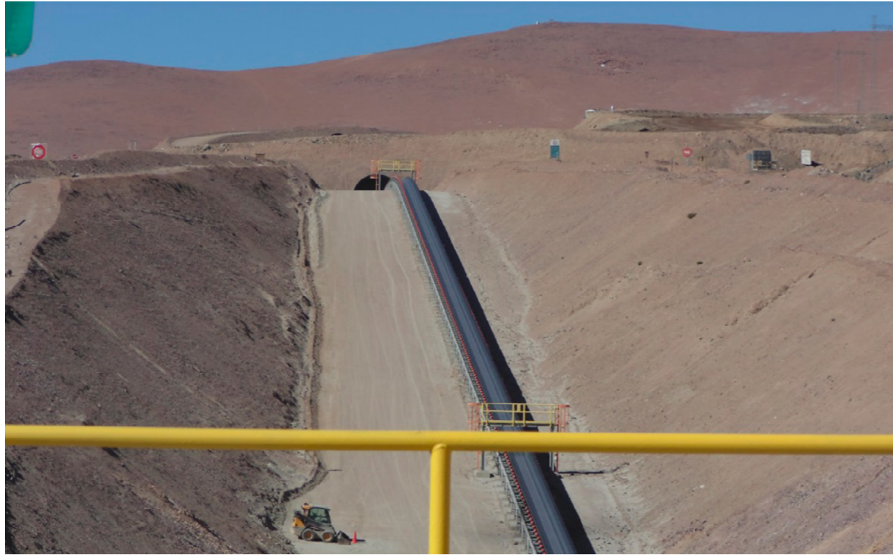
Рисунок 7.1 — Транспортирование руды конвейером (Чили)
