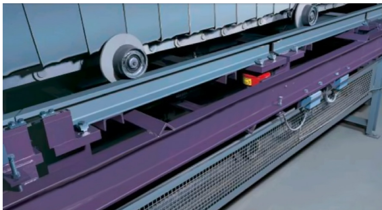
Рисунок 2.52 — Внешний вид лоткового конвейера медленного охлаждения
